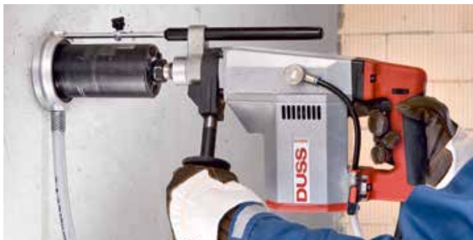
Dosensenken nass in Beton mit Wasserabsaugung
