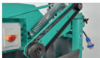
Getriebe mit drei gezahnten Trapezriemen und Keilscheiben.
