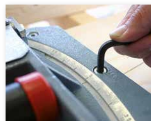
Das Schlitzgerät kann beidsei- tig bis 45° geschwenkt werden.
