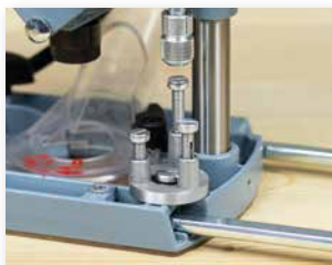
Schnelle Frästiefeneinstellung mittels stufenlos einstellbarem 3-fach Revolveranschlag.
