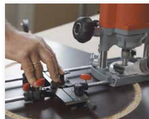
Der Mafell Oberfräsenadapter LO-FA kann als Frästaschenanschlag, als Führungsschielenadapter, Parallelanschlag oder Zirkel eingesetzt werden.
